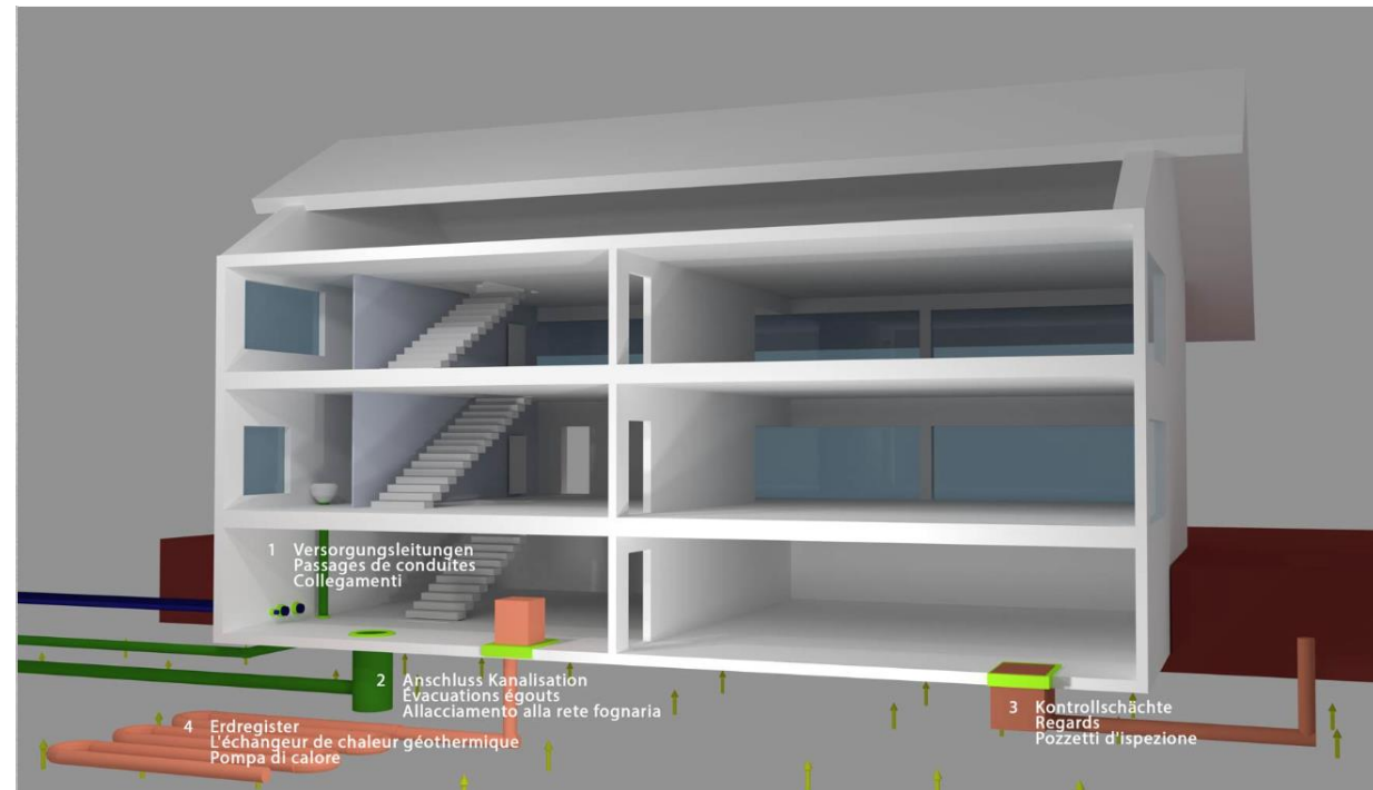
Typische Eintrittsstellen für Radon bei Neubauten
